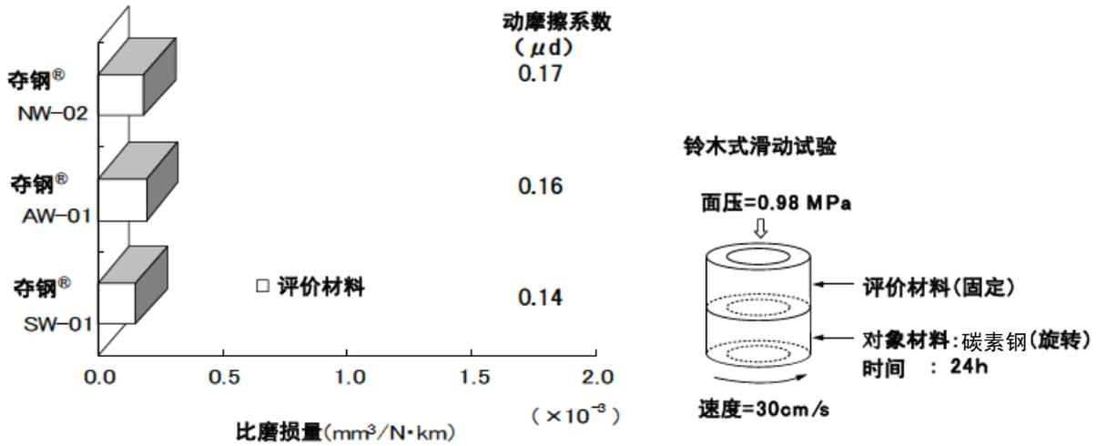
图 1-9 对PBT (DURANEX<sup>®</sup> PBT 751SA) 摩擦磨损特性 (往复滑动)
