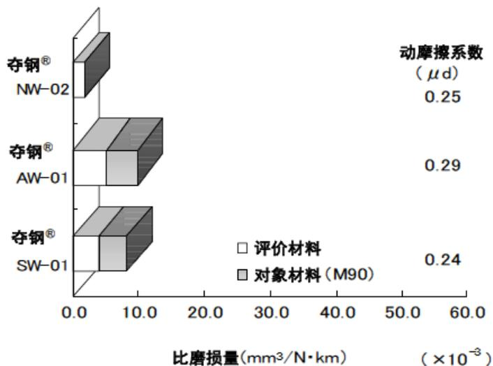
图 1-5 高负荷 摩擦磨损特性（往复滑动）
