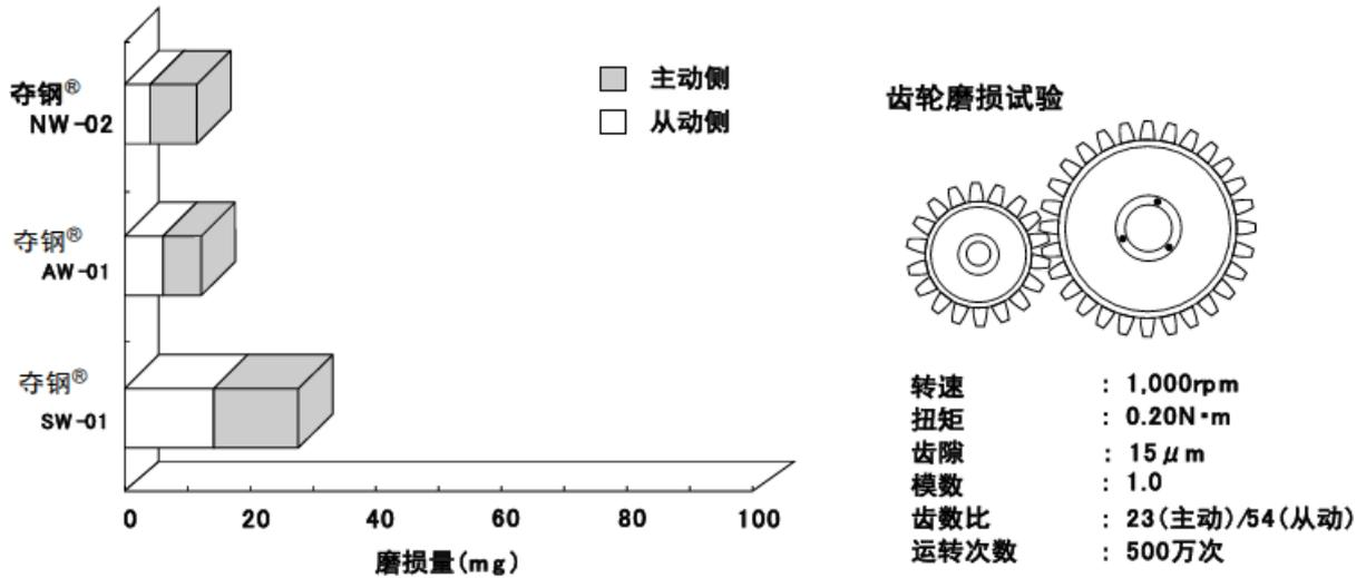
图 1-7 高负荷 齿轮磨损特性（同材）
