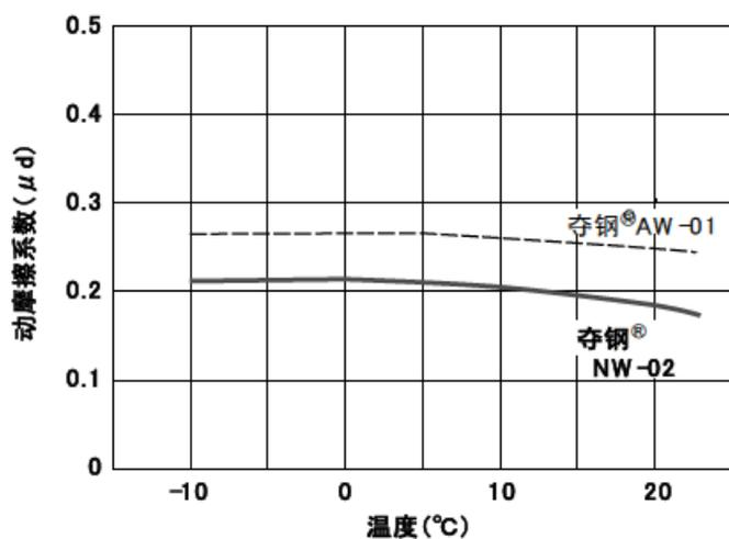
图 1-3 中负荷 摩擦磨损特性（铃木式滑动）
